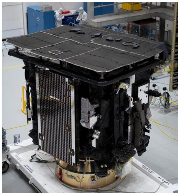
Le satellite Solar Orbiter à son arrivée en Floride pour la campagne de lancement (à gauche) et juste avant son couplage au lanceur Atlas V (à droite). La masse totale au lancement est de 1800 kg avec une charge utile de 180 kg (dix instruments). Une fois les panneaux solaires déployés, l'envergure atteint 18 mètres. Crédit : ESA.
