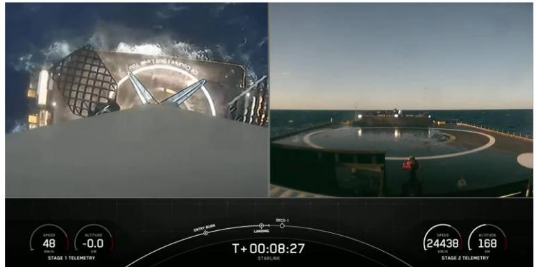
**Arrivée du 1<sup>er</sup> étage sur OCISLY, allumage moteur, et déploiement des pieds - © SpaceX**
